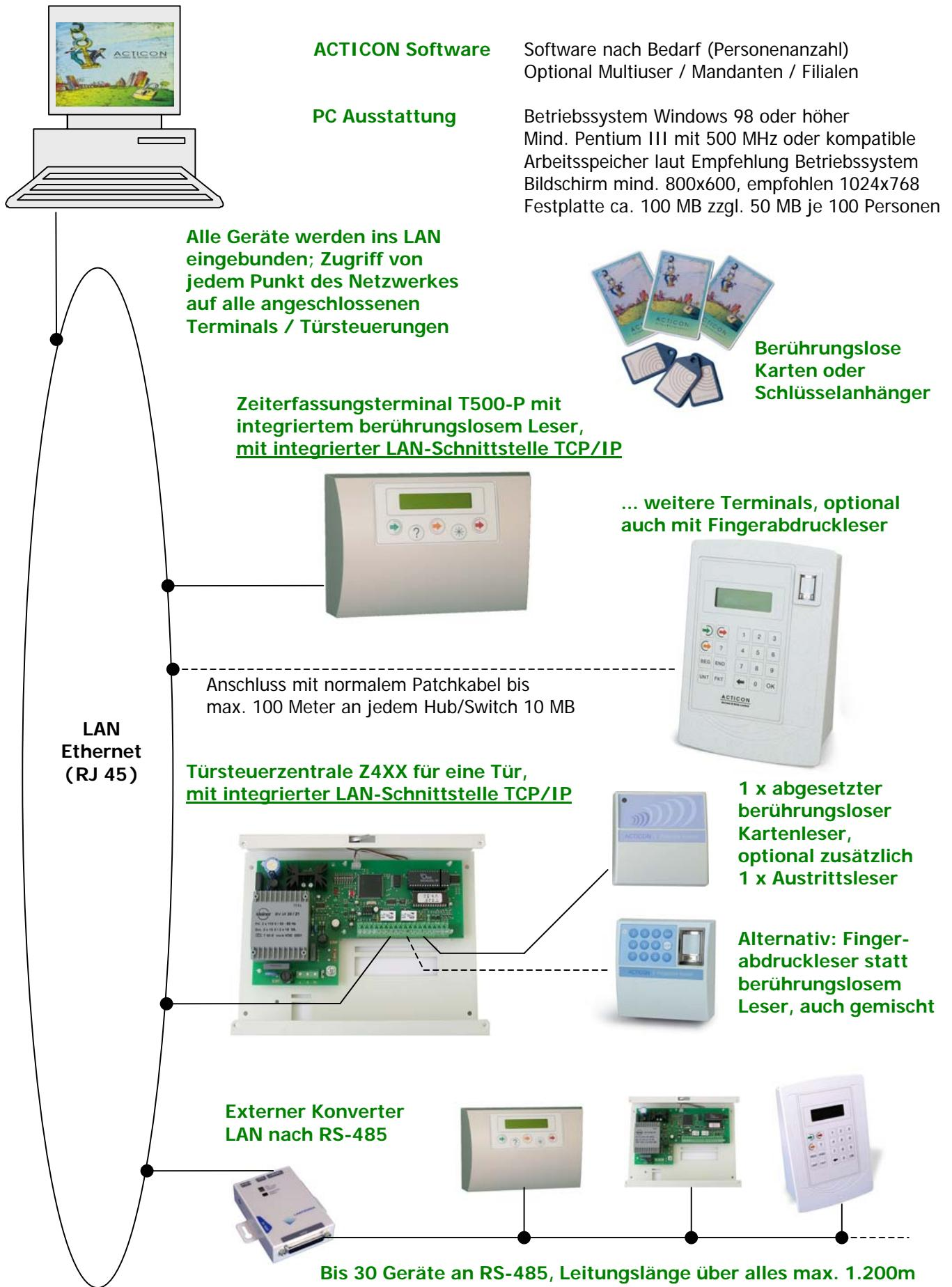
Es sind alle Übertragungsmedien möglich: RS-232, RS-485, Modem, Funkmodem, (W)LAN, GSM
